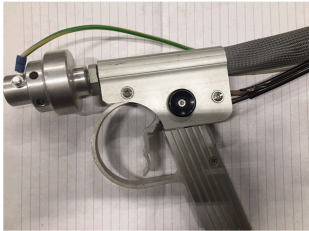
Figuur 1.0: Aarding nozzle t.b.v. straalpistool
